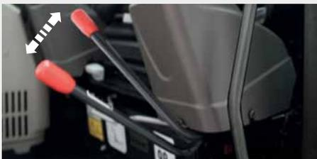
рычаг безопасности при входе в кабину
