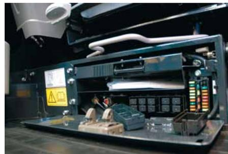
Поднятие капота, расположенного справа от кабины, обеспечивает доступ к ремню вентилятора (радиатора). Аккумуляторная батарея, защищённая металлической пластиной, находится справа от заднего капота. Электрооборудование машины размещено под сиденьем оператора.
