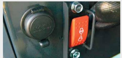
отключение двигателя с помощью электрического выключателя (экстренная остановка)
