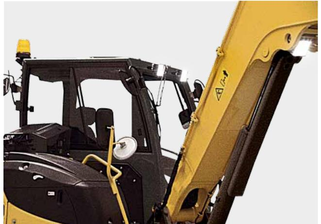
рабочие операции в тёмное время суток. Одна фара закреплена в нижней части стрелы и две на крыше кабины спереди. На машине могут быть также установлены проблесковый маячок и ещё одна светодиодная фара рабочего освещения позади кабины (не входят в базовую комплектацию).
