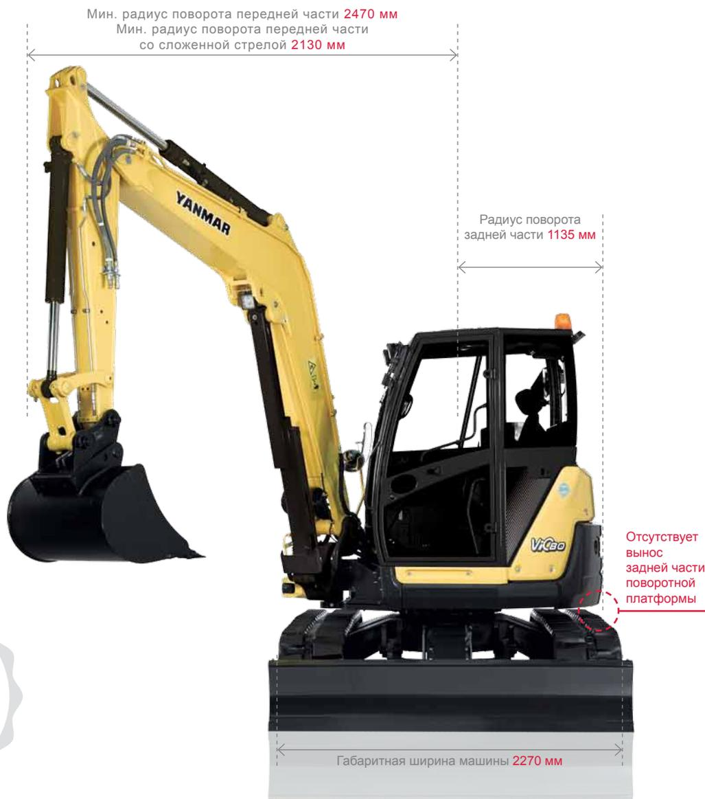
**Ни противовес, ни части поворотной платформы не выходят за ширину гусеничной тележки**
