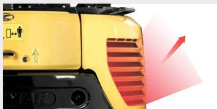
отвод охлаждающего воздуха двигателя вверх в целях безопасности человека и окружающей среды
