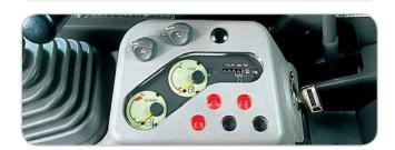
Удобно расположенная панель приборов с контрольными лампами позволяет отслеживать уровень масла, температуру охлаждающей жидкости и уровень зарядки аккумуляторной батареи. Благодаря этому возможные проблемы могут быть быстро обнаружены.
