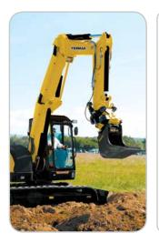
Облегчённая конструкция стрелы из стали с высокой эластичностью (в 1,5 раза эластичнее обычной стали) позволила уменьшить вес, следствием чего явилось увеличение устойчивости и грузоподъёмности экскаватора.
