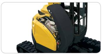
Открытие капота бокового отсека даёт возможность контролировать: уровень гидравлического масла и охлаждающей жидкости, зарядку аккумуляторной батареи, заполнение топливного бака и т.д.
